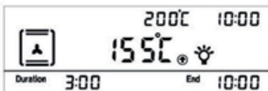
a/ Pulse el interruptor durante 3 s para configurar la hora actual. Ajuste el número de la hora pulsando **+ / -**. Y pulse **SELECT** seleccionar para confirmar la configuración.
