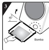
La máquina se inclina 40 grados, el lado con brecha de ángulo recto está hacia la parte frontal de la lavadora, el lado con brecha de bisel se inserta entre los dos tornillos de pie en la parte trasera de la lavadora hasta que esté insertado completamente, luego cierra el piso para que se pueda cercar del fondo de la lavadora.
