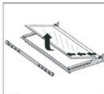
En cuanto al vidrio que queda en el interior, primero tire de él ligeramente hacia usted en la dirección de la flecha como se muestra en la Figura y levante ligeramente los soportes inferiores, luego levántelo ligeramente hacia arriba.
