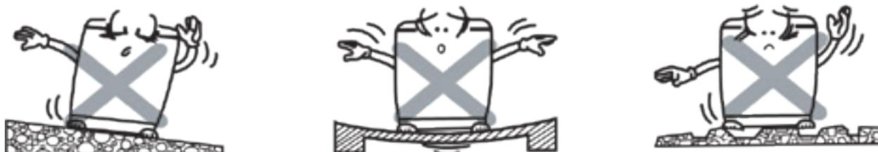
La lavadora debe colocarse lo más suavemente posible. Si es necesario, ajuste las patas de apoyo (patas de ajuste) en la parte delantera de la lavadora para mantener la lavadora nivelada.
