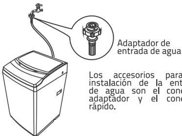
Los accesorios para la instalación de la entrada de agua son el conector adaptador y el conector rápido.
