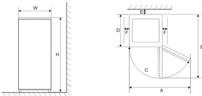
Nota: Figura 1, Figura 2 solo como un diagrama esquemático del tamaño de la demanda de espacio del producto.
