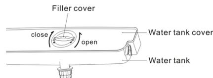
2. Abra la tapa de llenado del tanque de agua, llene lentamente el tanque de agua para evitar derrames hasta que el tanque se llene. Luego cierre la tapa de llenado del tanque de agua. **Ver imagen C.**
