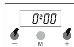
2) Para seleccionar Modo Manual, Pulse + y - al mismo tiempo
