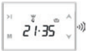
1) Presione botón M dos veces 2) Entre el tiempo usando ▲▼ 3) En pocos segundos la pantalla vuelve a mostrar la hora de alarma.
