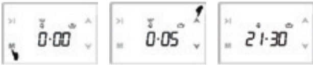
1) Presione botón M dos veces 2) Entre el tiempo usando ▲▼ 3) En pocos segundos la pantalla vuelve a mostrar la hora de alarma.
