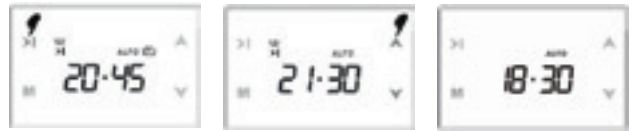
1) Presione botón >| . Aparece en pantalla cuándo estará pronta la comida 18:30 + 2:15 = 20:45 2) Ajuste hora de finalización usando ▲ ▼ 3) En pocos segundos la pantalla vuelve a la hora actual.
