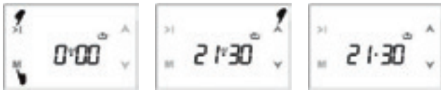
1) Seleccionar Modo Manual 2) Seleccionar la hora ▲ ▼ 3) En pocos segundos el punto parpadeante queda fijo.
